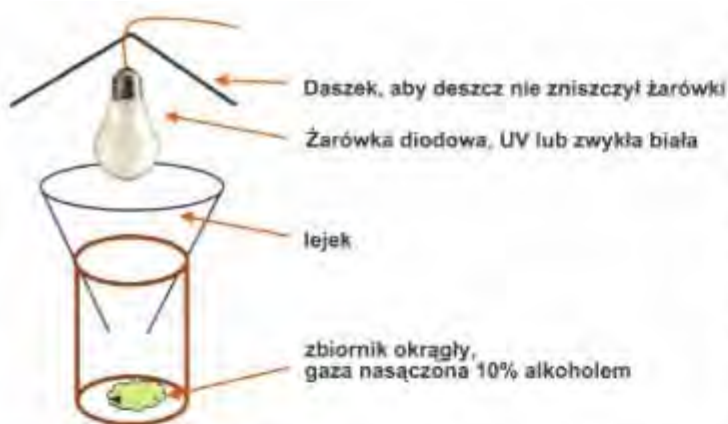
Rys. 1. Schemat budowy pułapki świetlnej tzw. samolówki
