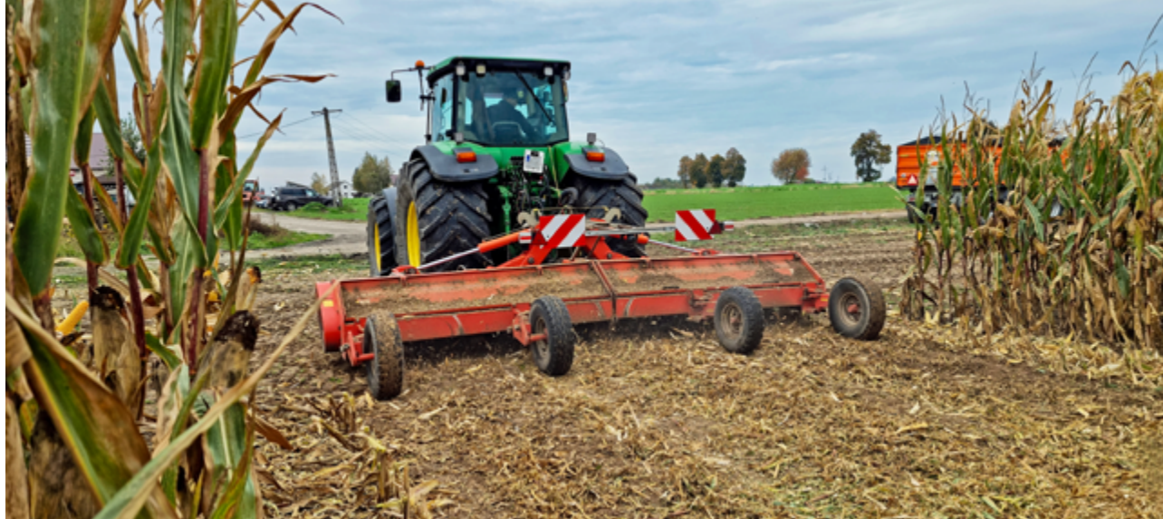
Mulczery skutecznie rozdrabniają resztki poźniwne (fot. P.K. Bereś)
