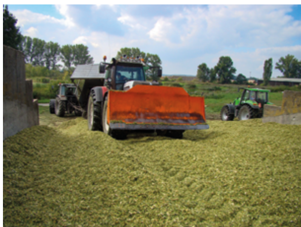
Fot. 2. Rozgarnianie i ubijanie. Ciągniki o dużej mocy są przydatne do rozgarniania i ubijania zakiszanej masy ponieważ mają napęd na 4 koła, dużą masę i mogą być wyposażone w szufle o dużej pojemności do wypychania i rozgarniania rozdrobnionych roślin kukurydzy (fot. I. Kowalik)
