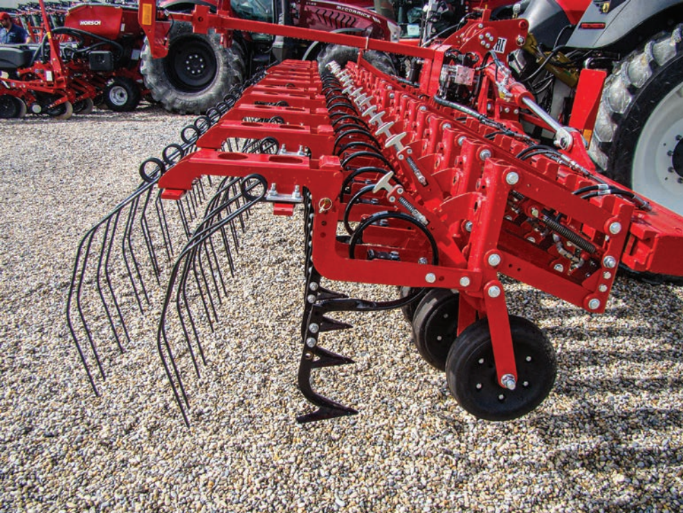
Fot. 2. Pielnik Transformer VF może być wykorzystywany do zwalczania chwastów w roślinach uprawianych przy rozstawie rzędów 15-80 cm (fot. I. Kowalik)
