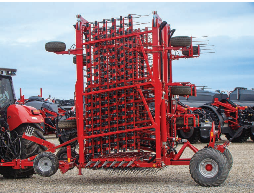
Fot. 1. Zastosowanie kół podporowych w bronie zgrzebło, zapewnia dokładną pracę zębów na ustalonej głębokości i skuteczne niszczenie chwastów (fot. I. Kowalik)
